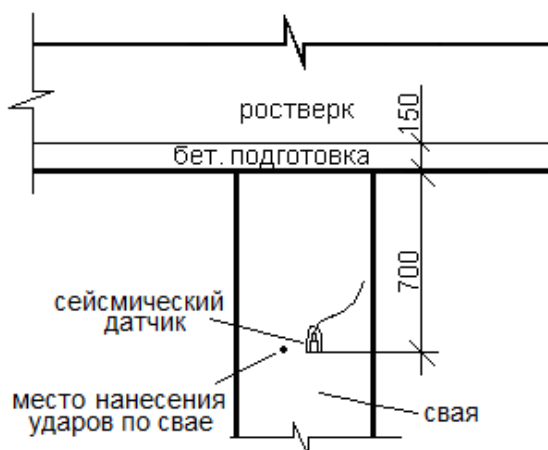
Рисунок 15. Схема установки сейсмического датчика на железобетонной свае № 2 для измерения ее длины с использованием измерителя «ИДС - 1»
