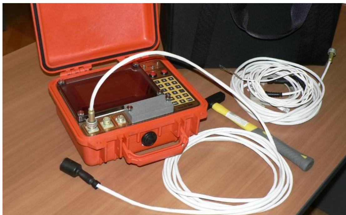
Рисунок 39. Измеритель «ИДС – 1» для определения длины свай методом отражении механического колебания от границы раздела сред с разными физическими свойствами
