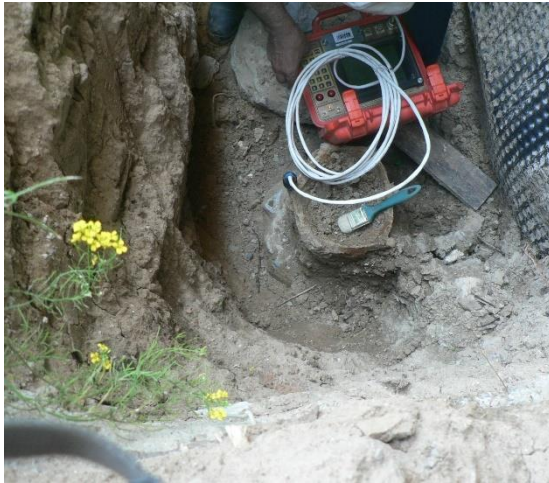
Рисунки 23 и 24. Проведение измерений длины железобетонных свай №№ 3 (слева) и 4 (справа) с использованием армокаркаса сваи с возбуждением продольных упругих волн ( V = 5100 м/сек) ударом молотка P = 200 гр.
