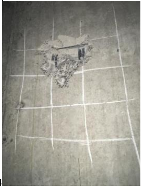
Фото 33, 34. Определение диаметра армирования монолитной стены (диафрагмы жесткости) 18-этажной части здания в осях 1-20, А-Д
