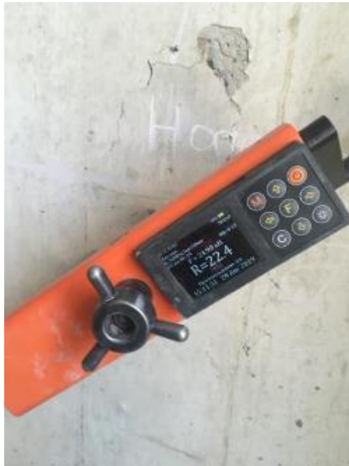
Фото 39, 40. Определение прочности бетона методом отрыва со скалыванием
