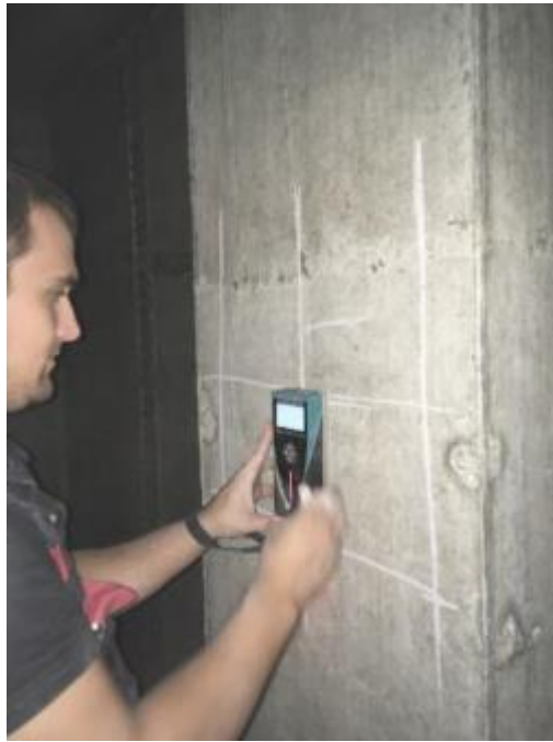
Фото 36, 37. Определение расположение и защитного слоя арматуры в монолитной стене (диафрагме жёсткости)
