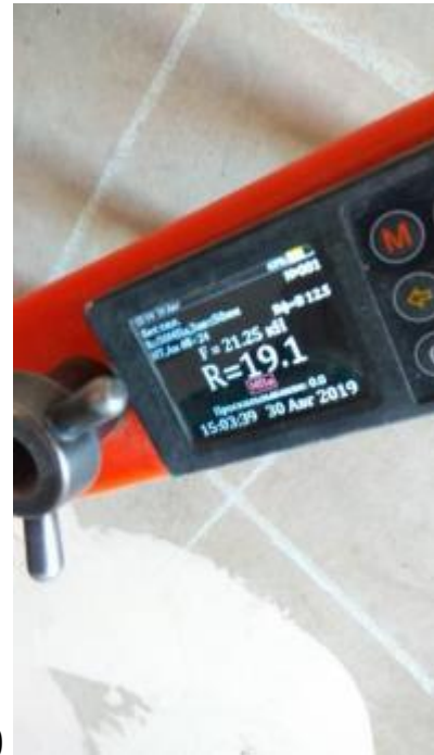
Фото 39, 40. Определение прочности бетона методом отрыва со скалыванием
