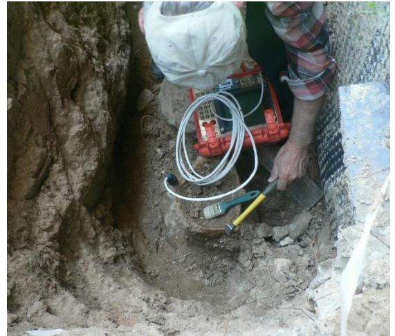
Рисунки 23 и 24. Проведение измерений длины железобетонных свай №№ 3 (слева) и 4 (справа) с использованием армокаркаса сваи с возбуждением продольных упругих волн ( V = 5100 м/сек) ударом молотка P = 200 гр.
