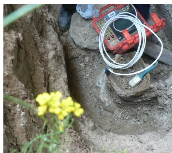
Рисунки 10 и 11. Площадки на торцевых поверхностях монолитных железобетонных свай построечного изготовления №№ 3 и 4, подготовленные для установки сейсмических датчиков измерителя «ИДС - 1»
