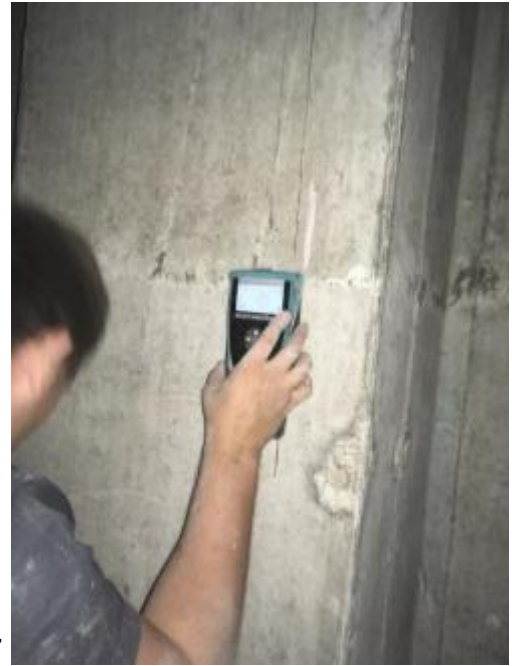
Фото 36, 37. Определение расположение и защитного слоя арматуры в монолитной стене (диафрагме жёсткости)
