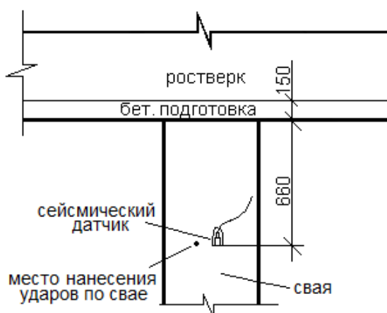
Рисунок 13. Схема установки сейсмического датчика на железобетонной свае № 1 для измерения ее длины с использованием измерителя «ИДС - 1»
