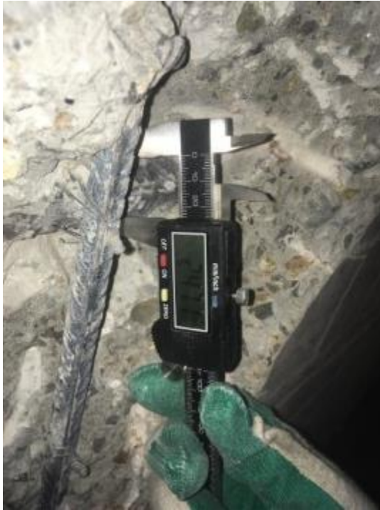
Фото 33, 34. Определение диаметра армирования монолитной стены (диафрагмы жесткости) 18-этажной части здания в осях 1-20, А-Д
