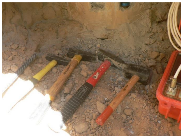
Рисунок 12. Молотки различной массы для возбуждения продольной упругой волны в железобетонной свае
