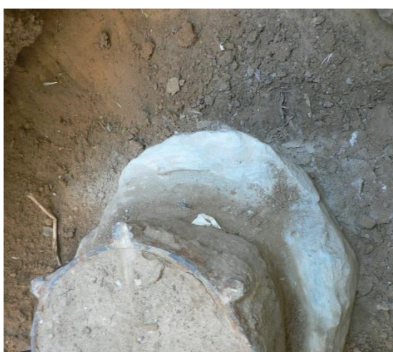
Рисунки 10 и 11. Площадки на торцевых поверхностях монолитных железобетонных свай построечного изготовления №№ 3 и 4, подготовленные для установки сейсмических датчиков измерителя «ИДС - 1»
